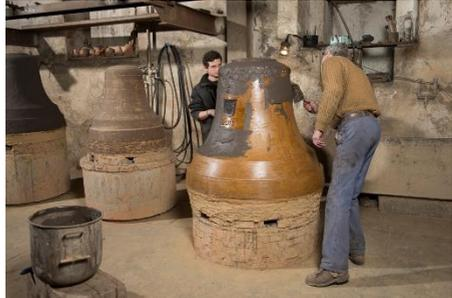
Für die Gussvorbereitung wird der Mantel abgehoben und die falsche Glocke zertrümmert. Nach dem Wiederaufsetzen des Mantels auf den Kern ist damit der Hohlraum für die Aufnahme der Glockenspeise (flüssige Bronze) entstanden.
