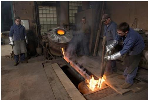
Die etwa 1100 °C heisse Glockenspeise wird aus der Ofenwanne über einen Kanal in den Einguss der Giessform geleitet. Die Glockenspeise oder Glockenbronze besteht aus 78 bis 79 Prozent Kupfer und 21 bis 22 Prozent Zinn. Die Qualität einer Glocke hängt weitgehend von der Güte des Metalls ab
